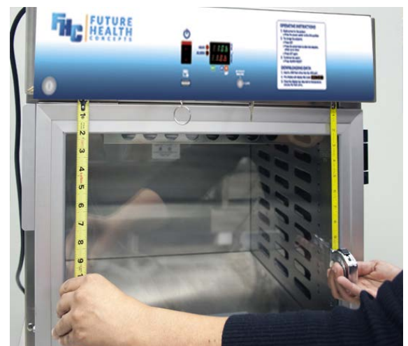
Fig. 56: Check Alignment - Square Door
