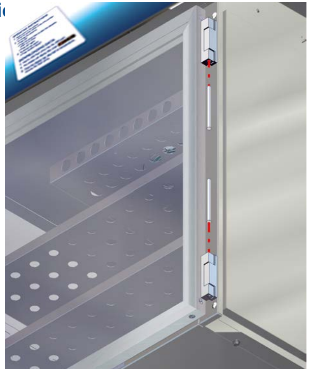
Fig. 45: Remove Door Hinge Pins
